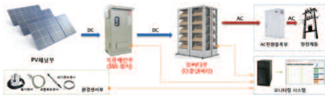
〈SSS 기술이 적용된 고효율 태양광발전 시스템 구성〉
